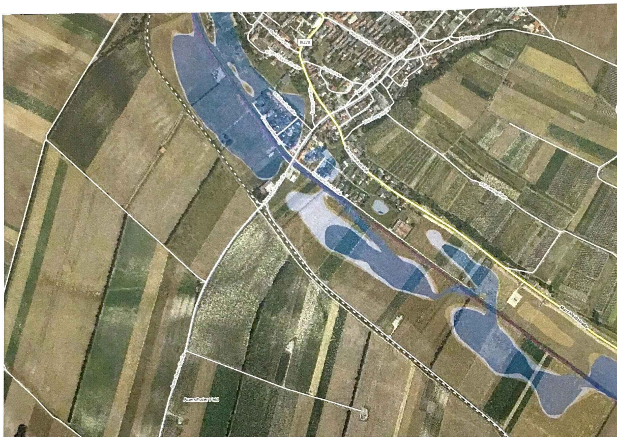
Abbildung 15 HQ100-Gefährungen im Bereich der Widmungsfläche
